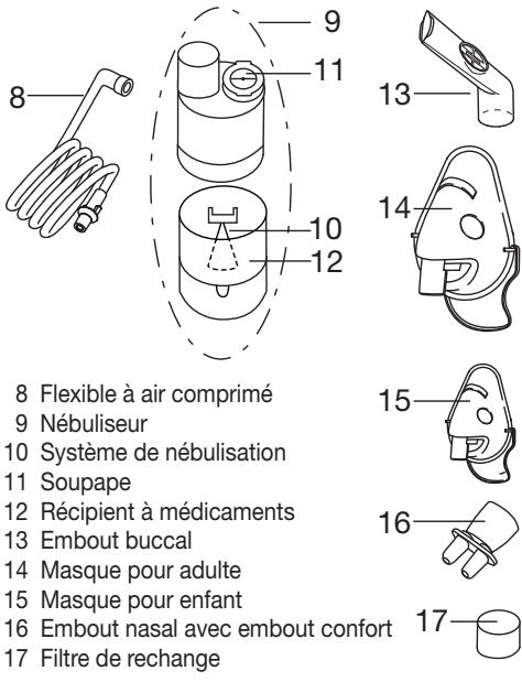
8 Flexible à air comprimé
